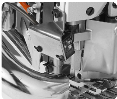
Герметичный комплект для всасывания отходов
