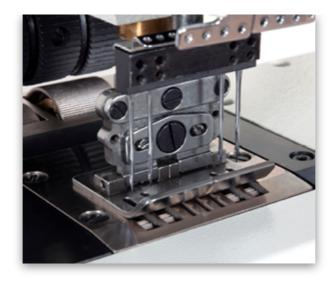
Можно синхронно регулировать подачу иглы и подачу материала
