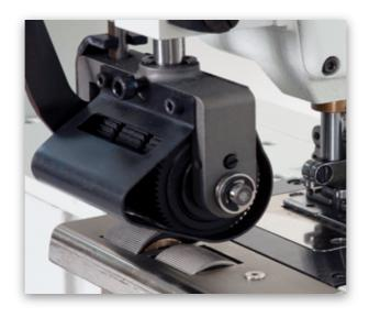
Задний пуллер обеспечивает стабильную подачу материала и хорошо сбалансированный шов.
