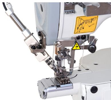
Автоматическая обрезка с новым разработанным верхним держателем нити обрезает нить точно и стабильно.
