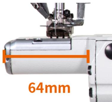
Конструкция платформы позволяет быстрое размещение / удаление материала. Длина цилиндра 64 мм облегчает пошив манжет с длинными рукавами.
