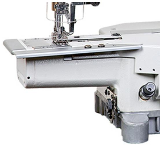
Серия C007J возвращается по запросу многих клиентов. Механизм подачи J-типа. Кроме того, машина оснащена новым триммером и регулятором натяжения нити.
