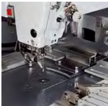
HM 快速換模 Template fast changing
